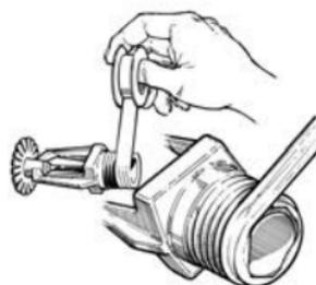
N'utilisez aucun produit d'étanchéité sur les adaptateurs de tête scellée à joint.
