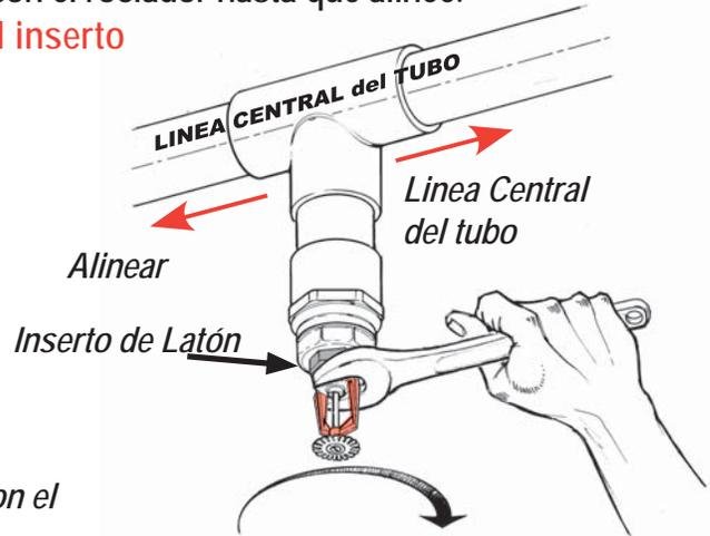
**No dé marcha atrás o retroceda el ensamble roscado. Sí está sobre ajustado continúe la rotación en sentido del reloj hasta que alinee bien.**
