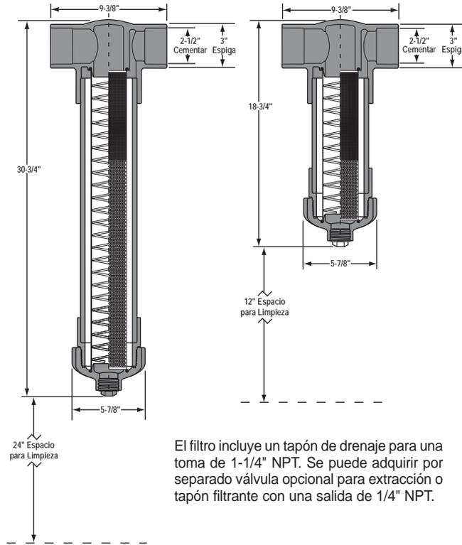
El filtro incluye un tapón de drenaje para una toma de 1-1/4" NPT. Se puede adquirir por separado válvula opcional para extracción o tapón filtrante con una salida de 1/4" NPT.
